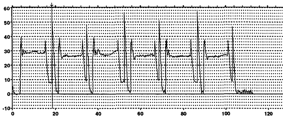
Рис.12.5. График зависимости уровня звукового давления от времени для 6 пробегов лифта
